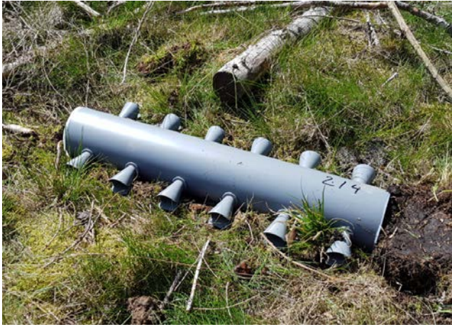
Abbildung 3a: WitaTrap Rüsselkäferfangrohr (Quelle: Sven Sonnemann)
